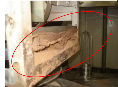
Puntos de acumulación de producto (puntos muertos)
