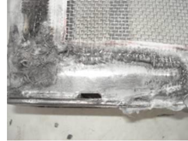
Deterioro de tamices
