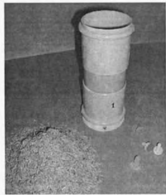
Anexo 1a. Vista fotográfica de uno de los porómetros utilizado en este experimento listo para ser llenado con la muestra
