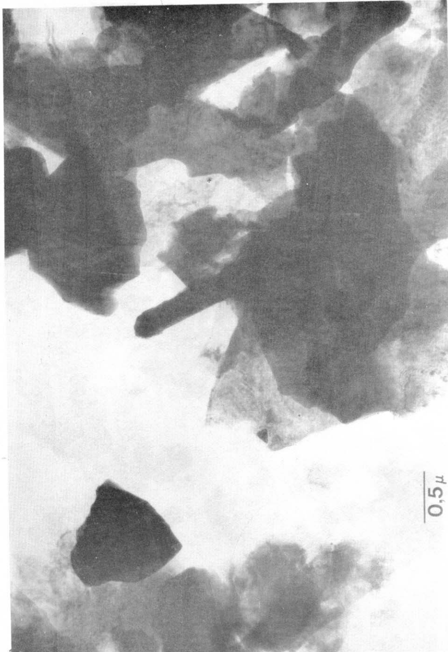
Figura 6. Ilita-muscovita, pirofilita y paligorskita-sepiolita. Horizonte Bw2, suelo Quíbor I. Fracción <2\mu .
