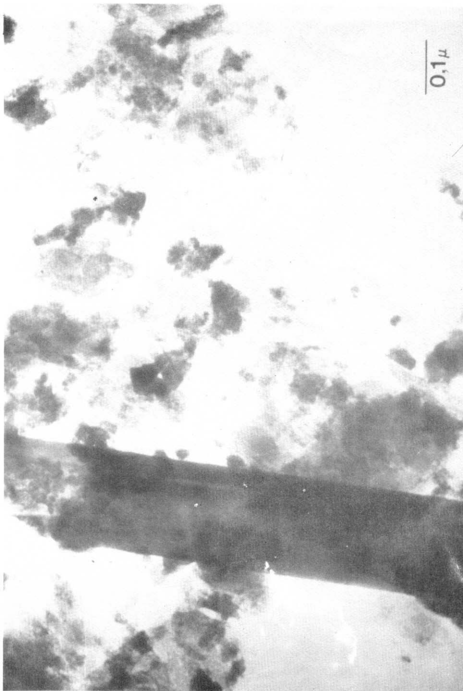
Figura 7. Halosita y alofanos. Horizonte Ap, suelo Cubiro. Fracción <2\mu
