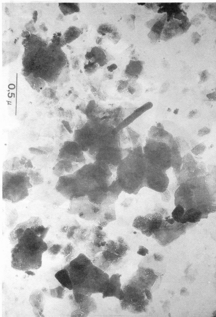
Figura 5. Ilita-muscovita, pirofilita, y paligorskita-sepiolita. Horizonte A, suelo Qusbor I. Fracción < 2 \mu .
