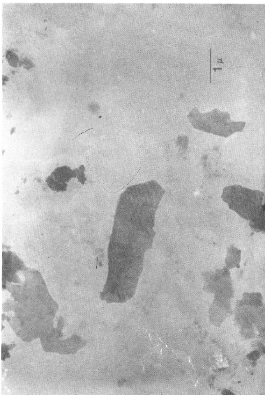
Figura 3. Pirofilita, illita-muscovita, cuarzo y calcita. Horizonte A3, suelo Turbio. Fracción < 2 \mu
